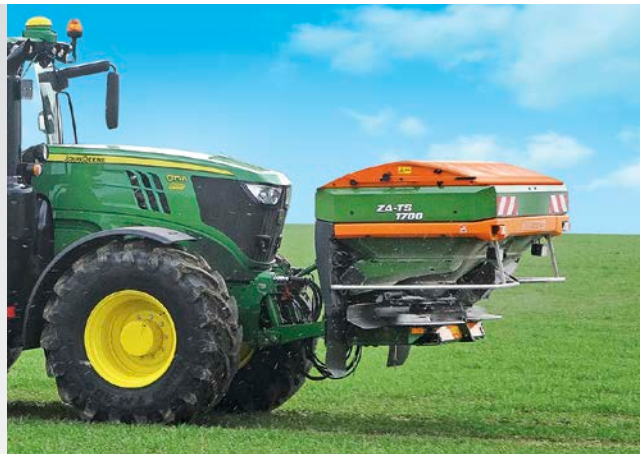
Čelně nesené rozmetadlo s osvětlením pro jízdu po veřejných komunikacích
