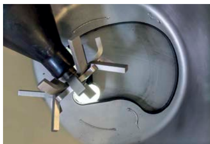
Stupeň 1: Částečně otevřené hradítko
