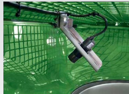
✔ Senzor indikující vyprázdnění u rozmetadla ZA-TS
