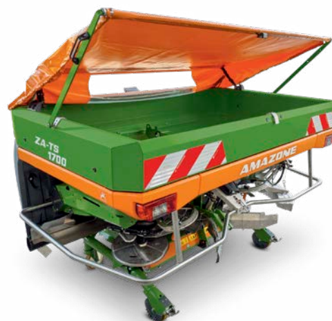
Krycí výklopná plachta v pozici pro provádění údržby – pro snadné vnitřní čištění
